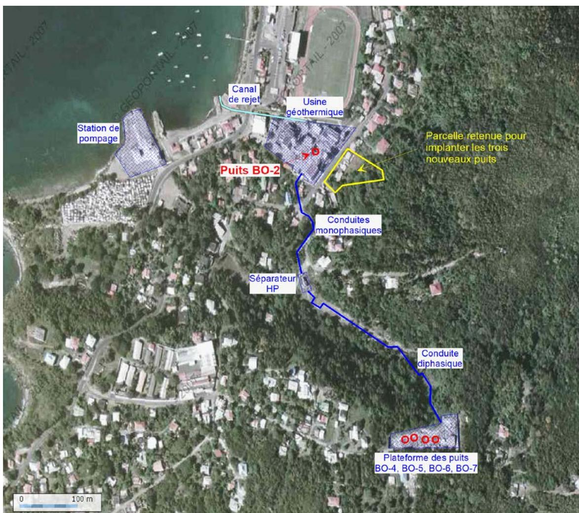
Figure 7 : Localisation du site de l'usine (ou centrale) géothermique de Bouillante et des sites déportés de l'exploitation au sein de l'agglomération de Bouillante (photographie aérienne ; source : Géoportail IGN).
