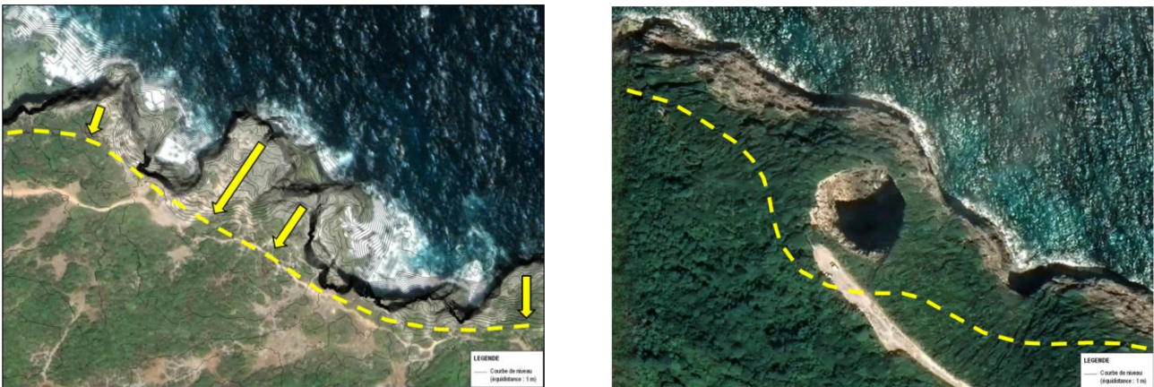
Figure 39 : Exemple d'estimation du recul potentiel des falaises au regard de la morphologie du trait de côte sur Grande-Terre (à gauche) et de prise en compte du sous-cavage au niveau de Gueule Grand Gouffre à Marie-Galante (à droite) [Source : Ginger CEBTP]
