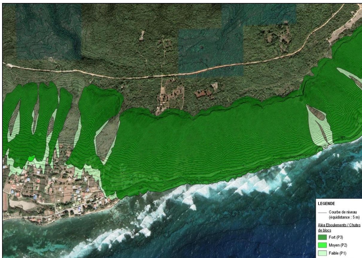
Figure 36 : Extrait de l'aléa Eboulements / Chutes de blocs finalisé sur La Désirade [Source : Ginger CEBTP]
