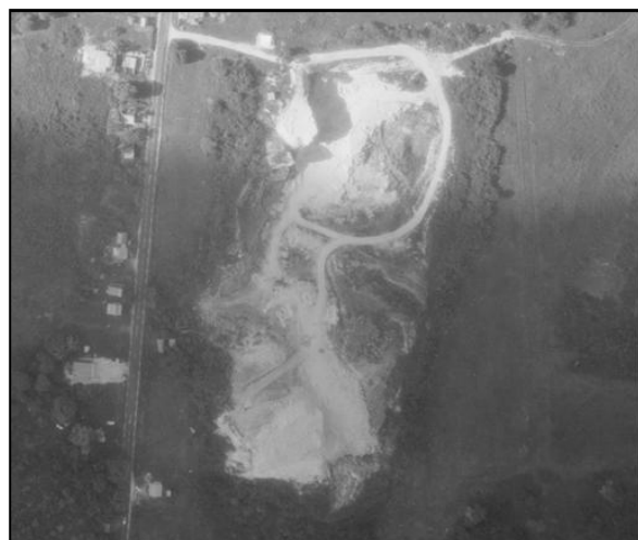
Figure 28 : Exemple de dépression sur la commune de Petit-Canal (à gauche) [Source : Ginger CEBTP] correspondant à une ancienne carrière visible sur la photo aérienne IGN de 1978 (à droite) [Source : https://remonterletemps.ign.fr/ ]
