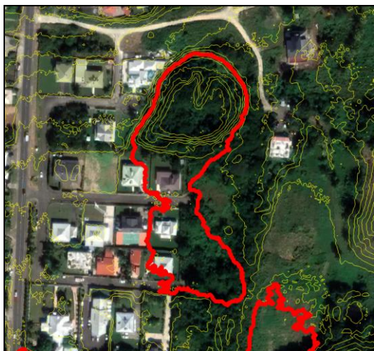
Figure 28 : Exemple de dépression sur la commune de Petit-Canal (à gauche) [Source : Ginger CEBTP] correspondant à une ancienne carrière visible sur la photo aérienne IGN de 1978 (à droite) [Source : https://remonterletemps.ign.fr/ ]
