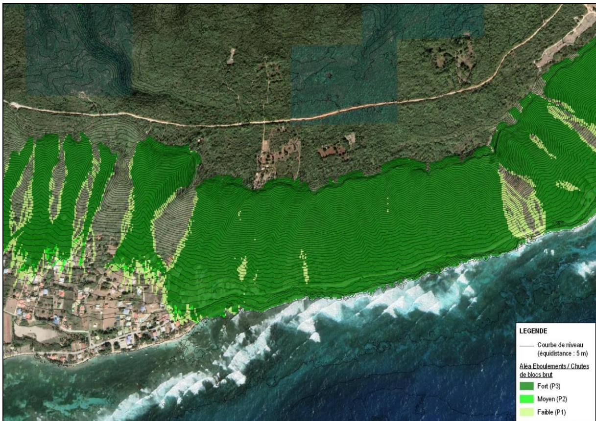
Figure 31 : Extrait de l'aléa Eboulements / Chutes de blocs brut issu du croisement entre l'énergie et la probabilité d'atteinte sur La Désirade [Source : Ginger CEBTP]
