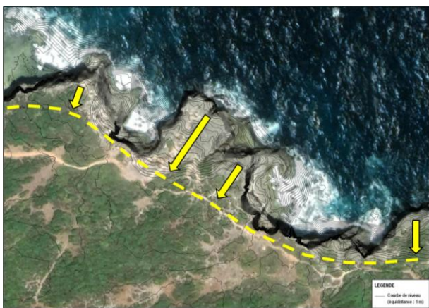
Figure 37 : Exemple d'estimation du recul potentiel des falaises au regard de la morphologie du trait de côte sur Grande-Terre (à gauche) et de prise en compte du sous-cavage au niveau de Gueule Grand Gouffre à Marie-Galante (à droite) [Source : Ginger CEBTP]
