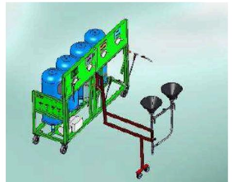
Autonomie des cuves avant vidange : 75l, Vidange vers cuves par raccords rapides, pompe à vide performante : 6m<sup>3</sup>/h, Indicateur du niveau des cuves - pas de pesées des fluides.
