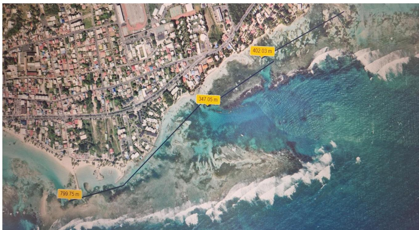
Figure 3 Prospections et mesures effectuées dans sur la plage de Castaing pour la mise en place de barrages anti-sargasses (source fond de carte : données libres google).
