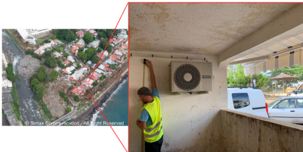
Relevé d'une PHE par un agent DEAL à Rivière des Pères après l'évènement
