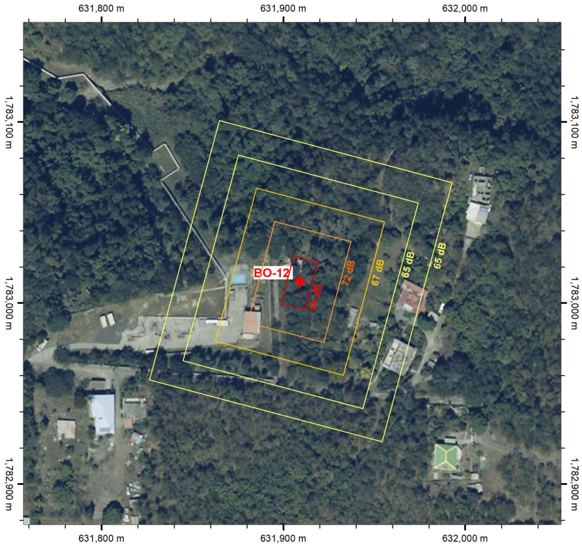
Figure 16 : Carte des niveaux de bruit générés par l'appareil de forage autour du site de forage du puits BO-12 en l'absence de mesures correctrices.
