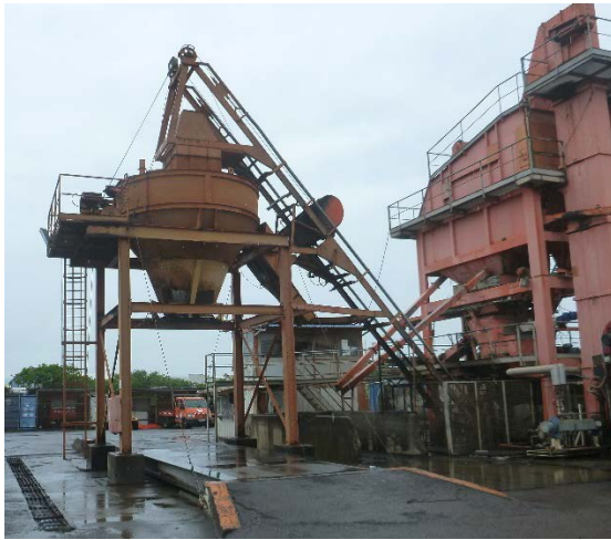
Chargeur d'enrobé et malaxeur
