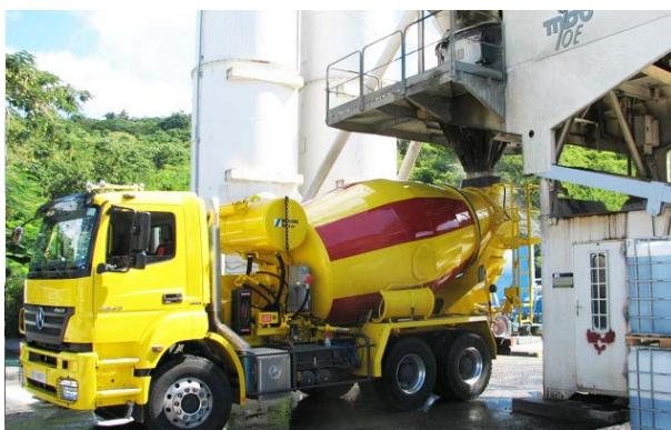
Illustration 18 : Chargement de la toupie pour le transport de béton (SGB).
